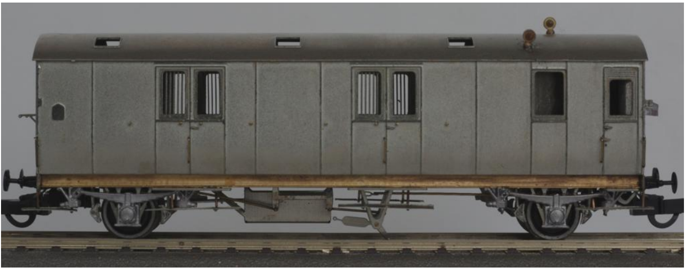
Ombygget med hvælvet tag - bemærk bremsetøjet, der stort set er uændret siden vakuumbremstens tid.
