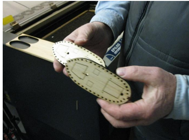
Så skal lagene sandwiches, på billedet man ser hvordan. Små pinde er sat i for at binde de to lag sammen, så pasformen kan tjekkes.
