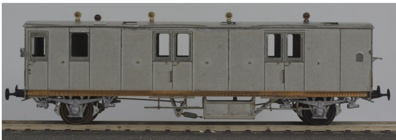
Ombygget med lige sider og fladt tag ilagt vinduer
