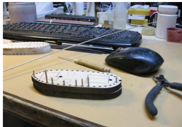
Så skal lagene sandwiches, på billedet man ser hvordan. Små pinde er sat i for at binde de to lag sammen, så pasformen kan tjekkes.
